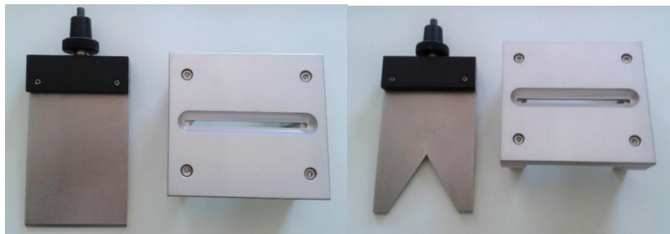
Fot. 2 . Zestaw noży (przystawki Warner-Bratzlera wyposażone w nóż płasko ścięty oraz z trójkątnym wycięciem) wraz ze stolikiem pomocniczym wykorzystywane do pomiaru siły cięcia (L. Lewko).
