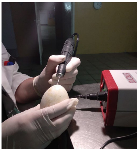
Fot. 2. Przygotowanie do iniekcji – nawiercanie otworu w skorupie.
