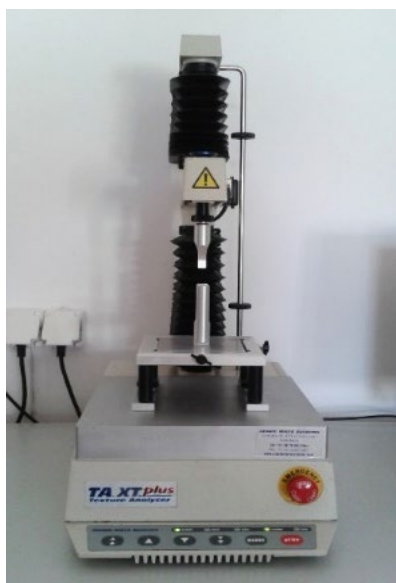
Fot. 1. Analizator tekstury TA.XT plus firmy Stable Micro Systems wraz z przystawką - tzw. uchwyty szczękowe Volodkievich'a - do określenia siły gryzienia (L. Lewko).
